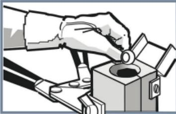
Cerrar la tenaza del molde y bloquearla en dicha posición, para evitar fugas de metal fundido durante la soldadura. Colocar el disco metálico, con la parte cónica hacia abajo, en el fondo de la
