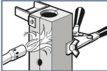
Antes de realizar la primera soldadura, es imprescindible precalentar el molde con una lámpara de soldar durante 5 minutos. De esta forma, se eliminará la humedad del molde y se evitarán soldaduras porosas.
